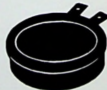
C 354/355 - 600 Volt 110 A gemiddeld t_{uit} 10/20 microsec max
